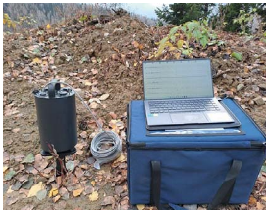
Рис. 3. Работа сейсмодатчика на «Разрезе «Коксовый» (Кузбасс, г. Междуреченск)
